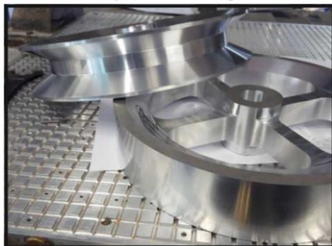
Aluminium gedreht  $d = 300$  mm
